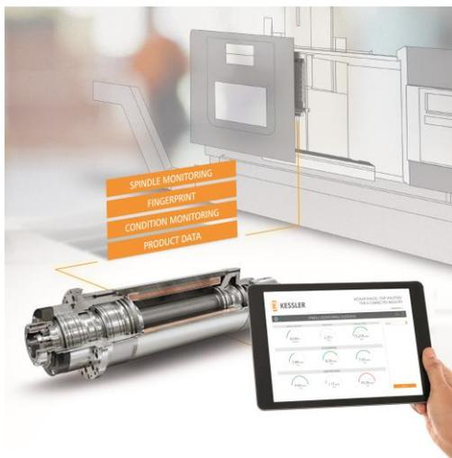
*Mit dem diaLOG System bietet KESSLER den Kunden eine Lösung zur intelligenten Datenverarbeitung und Zustandsüberwachung.*
